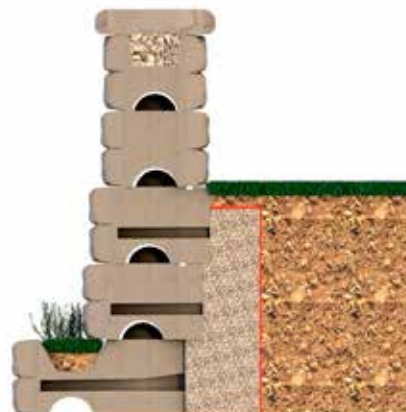
Abb.: Stützwandsystem mit ausgeformter Brüstung und Abdeckplatte
