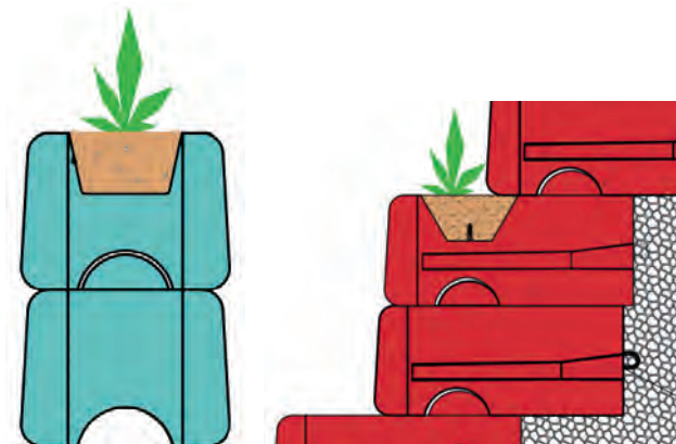
Abb.: Freistehendes System mit Pflanzstein
